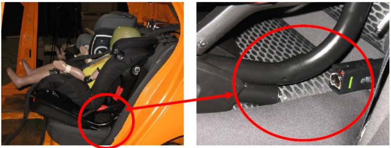
Figura 1: Una delle saldature del Casualplay Fix QR's si rompe al punto di fissaggio ISOFIX
