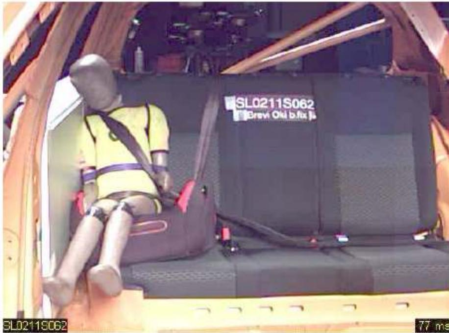
Figura 2: Esempio di un seggiolino senza schienale: la testa del manichino è senza protezione e urta violentemente contro la portiera della macchina
